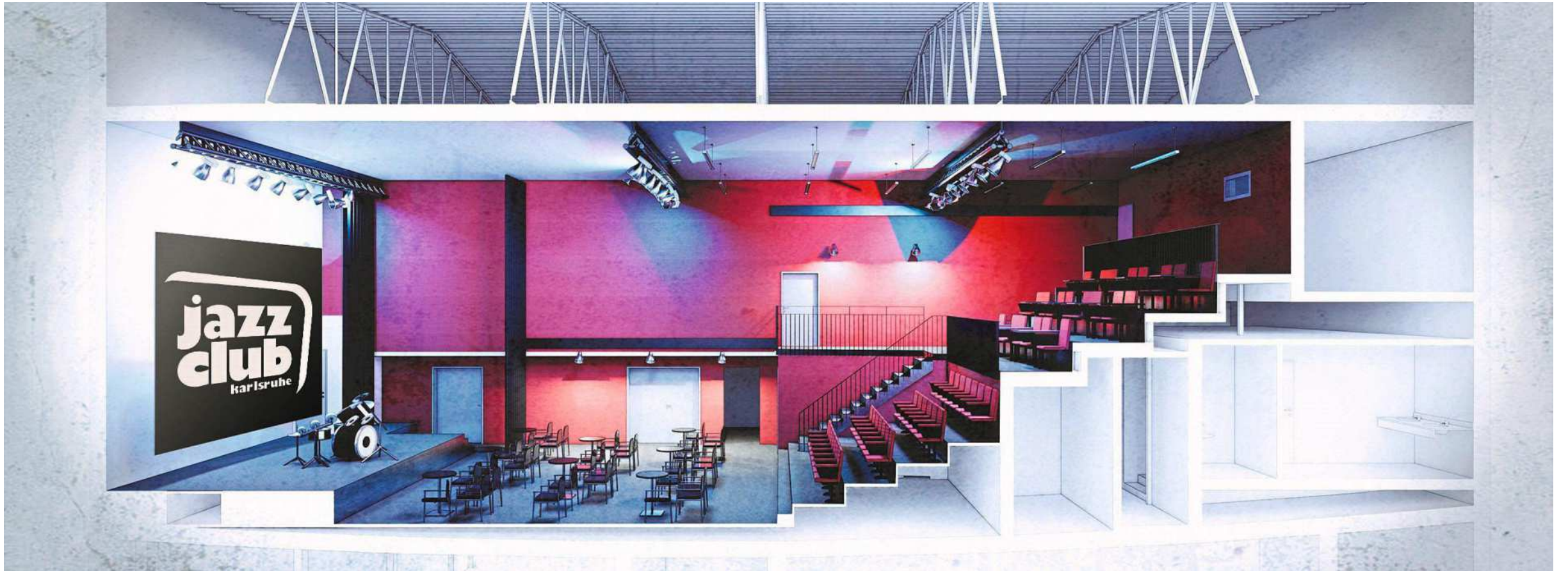
Querschnitt durch den künftigen Jazzclub: Auf dieser Simulation des Karlsruher Architekturbüros lennermann krämer erkennt man deutlich die neu eingezogene Decke und den Boden sowie die Empore, auf der 70 ehemalige Kinossessel platziert werden. Insgesamt soll der Konzertsaal im ehemaligen Kino „Kurbel 1“ Platz für bis zu 250 Besucher bieten. Foto: lennermann krämer architekten
